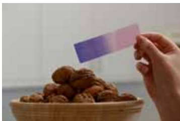
Sensorfolie für optische Frischekontrolle von abgepackten fetthaltigen Lebensmitteln. © Fraunhofer EMFT
