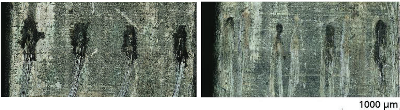
Abbildung 3.38: Oben: Diagramm Lebensdauer unter Rauschanregung (SG4) in Abhängigkeit der Anregungsrichtung und Befestigungsoption für Versuchsserie S1 und S2 mit G1 Steckhülsegehäuse am Beispiel der K1 Kontakte. Unten: Vergleich exemplarischer Verschleißprofile Versuchsserie S1 und S2 (3-POL) in Y-Anregungsrichtung
